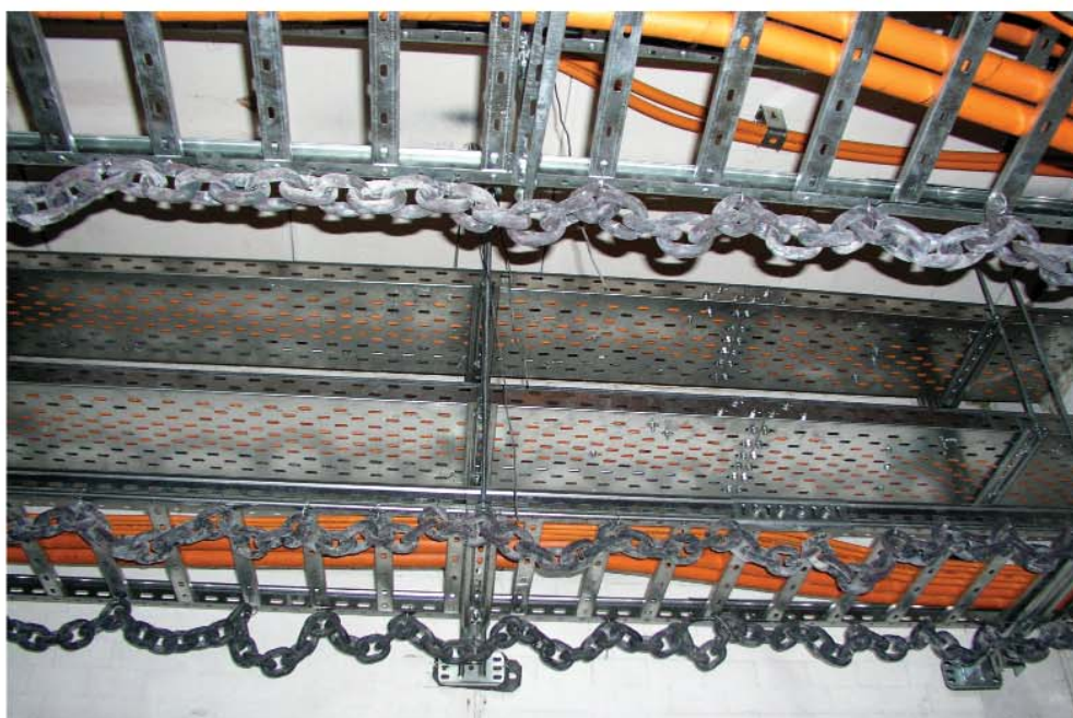
Снимок после испытания на огнестойкость.
