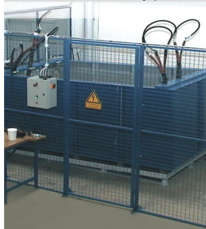
Контейнер с водой для произведения нагревательных циклов кабельных муфт
