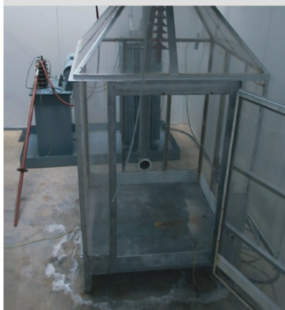
Камера соляного тумана с трансформатором AC (сменного напряжения) 50 кВ
